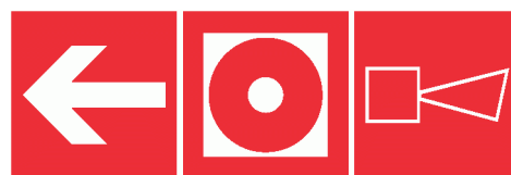
Кнопка включения установок пожарной автоматики и оповещателей налево
